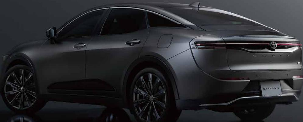
自動車の塗装は、耐久性や仕上がりを目的として数層の重ね塗りが施されています。一般的なクリア塗装は塗装面に艶を出して見栄えを良くする役割がありますが、マットクリア塗装はその艶を出さないようにすることで、独特の質感を表現しています。この質感を少しでも長く保つために、今回特殊表面処理を施していますが、日常のお手入れや保管のしかたに気を配る必要があります。
